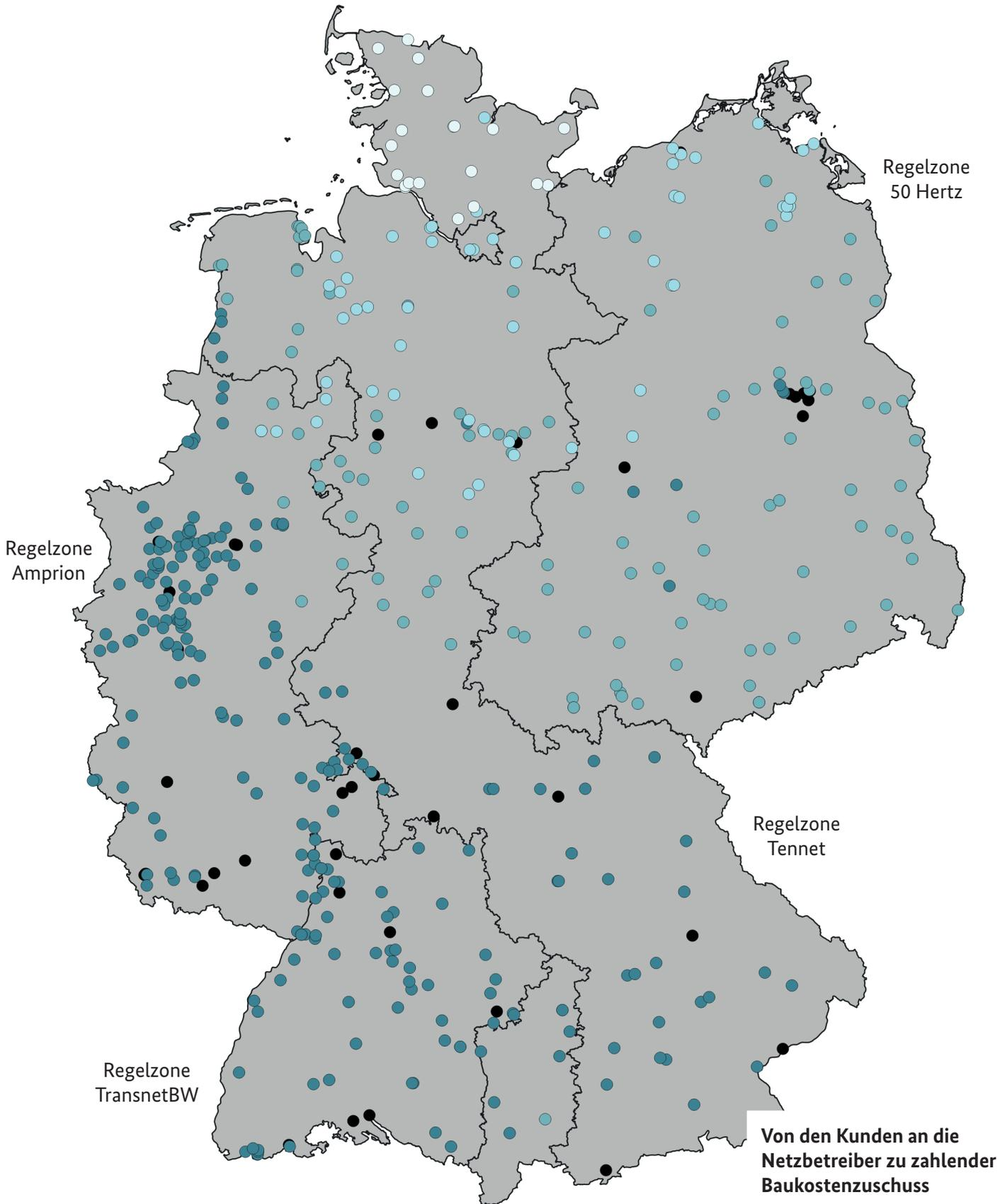
Die Karte der Übertragungsnetzbetreiber zeigt deutschlandweit verschiedene Netzknoten, an denen eine Differenzierung des Baukostenzuschusses sinnvoll sein kann. An helleren Netzknoten kann der Baukostenzuschuss stärker reduziert werden als an dunkleren Netzknoten. Es handelt sich dabei um eine vorläufige Berechnung durch die Übertragungsnetzbetreiber. Diese veröffentlichen die finalen Berechnungen voraussichtlich im Dezember 2024.
