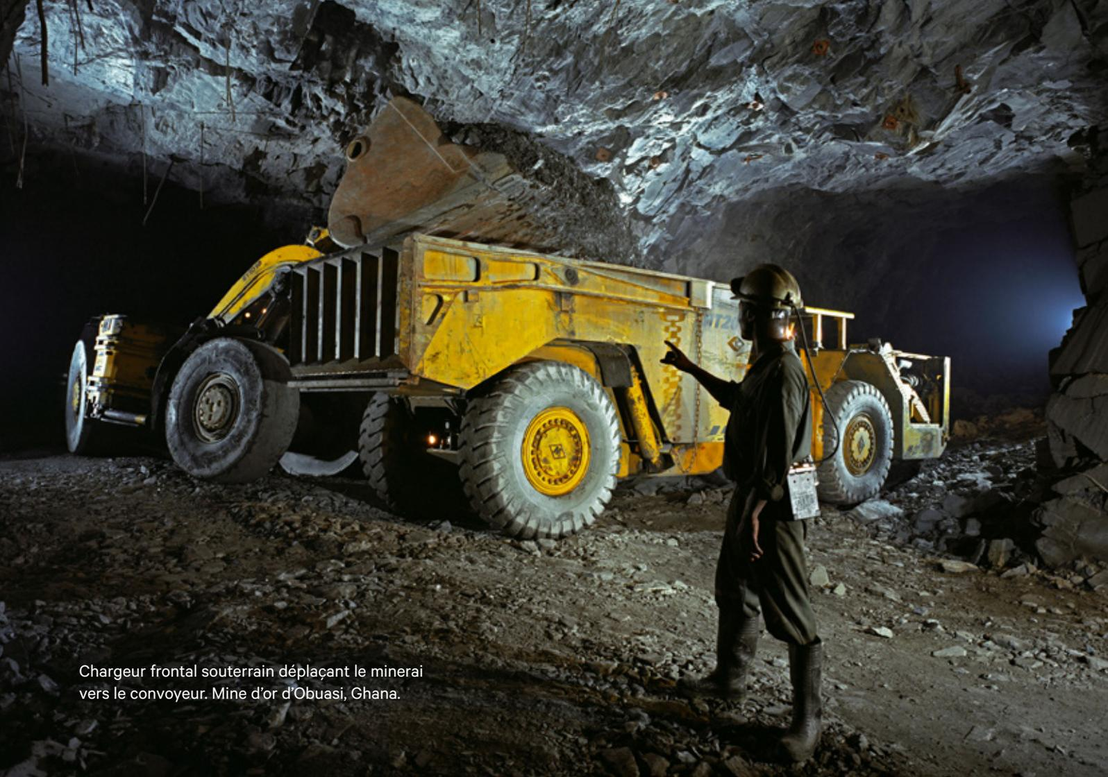
Chargeur frontal souterrain déplaçant le minéral vers le convoyeur. Mine d'or d'Obuasi, Ghana.
